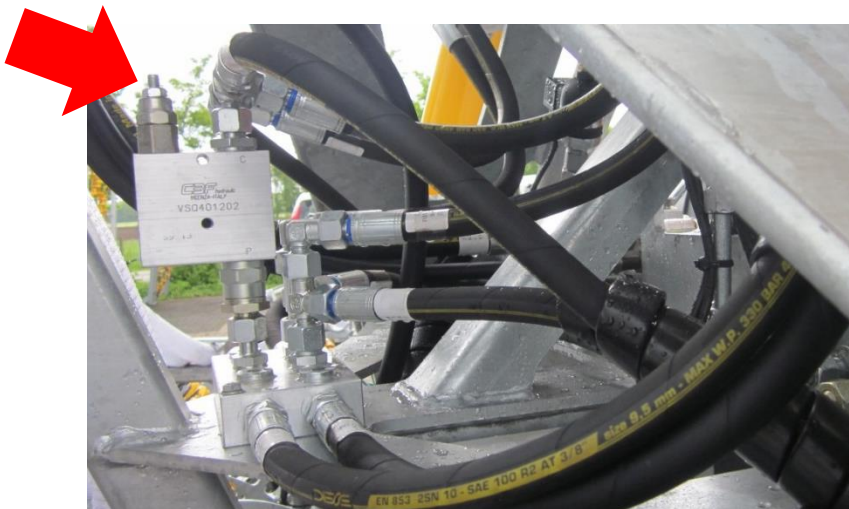
Instellen volgorde vergrendelhaken dit wordt af fabriek ingesteld.
