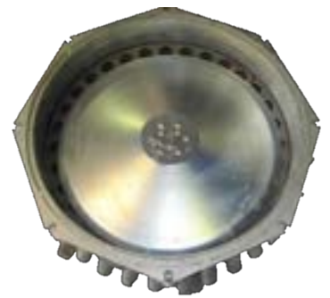
Binnenwerk excentriek verdeler
